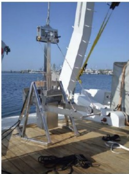
Figure 2 : Carottier boîte pour les prélèvements de sédiment
